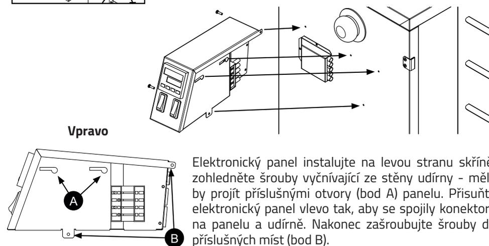
Elektronický panel instalujte na levou stranu skříň, zohledněte šrouby vyčnívající ze stěny udírny - měly by projít příslušnými otvory (bod A) panelu. Přisuněte elektronický panel vlevo tak, aby se spojily konektory na panelu a udírně. Nakonec zašroubujte šrouby do příslušných míst (bod B).
