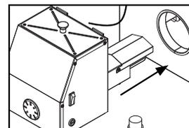
5. Zasuňte vyčnívající topný prvek generátoru kouře do bočního otvoru na levé straně udírny. Generátor mírně nakloňte a nasadte jej na držáky.
