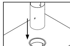
6. Komínek vsuňte do otvoru na horní straně udírny. Věnujte pozornost správné poloze škrticího ventilu.
